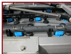
buses inox facilement démontables à la main
