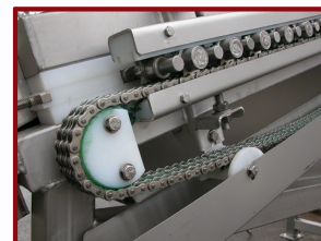
triple chaînes inox pignons inox guidage chaînes dans rails en PE
